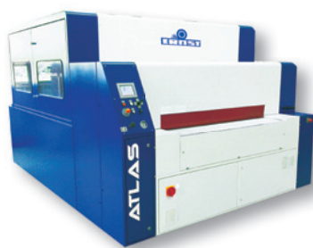
ATLAS ER (удаление грата + сильное скругление)
