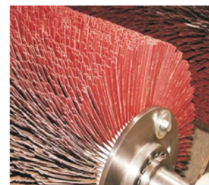
Скругление (2 щетки с абразивной лентой)
