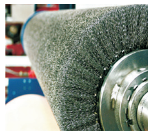
Притупление кромок (2 щетки из нержавеющей стали)
