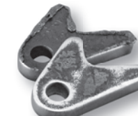
Удаление большого грата (после кислородной резки)
